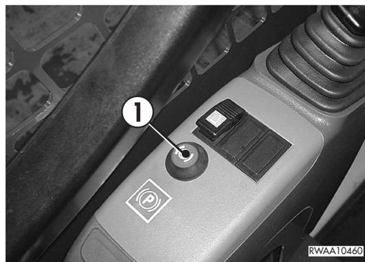
Тормоз включается нажатием на кнопку (1) (лампа загорается), а выключается повторным нажатием на ту же кнопку (лампа гаснет).
